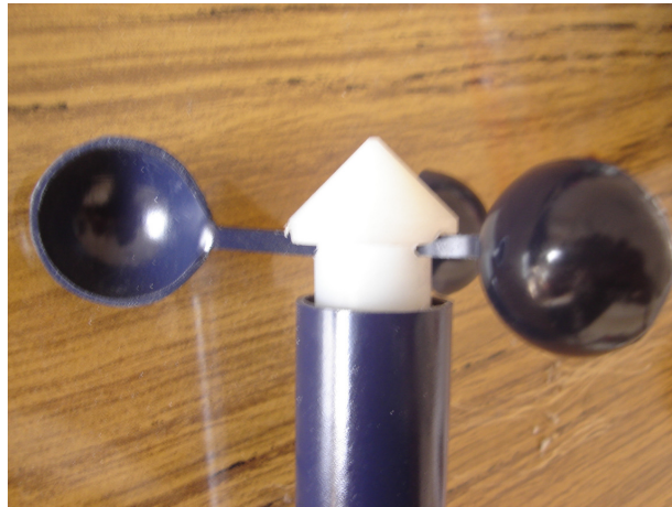
Figura 1. Vista lateral del anemómetro construido.
