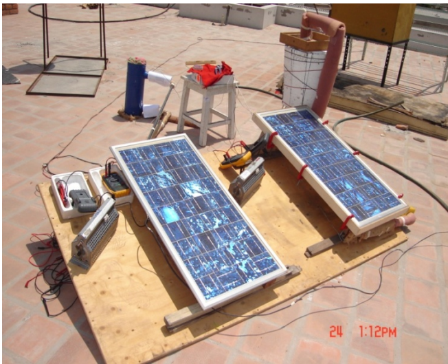
Figura 3.5: disposición de los paneles FV híbrido y normal. Con la bomba en funcionamiento y visto que la temperatura de la placa alcanzó un equilibrio de 35°C, a partir de 12:59 pm se procedió a tomar datos de corriente y voltaje para los dos sistemas (híbrido y normal) simultáneamente hasta la 13:10 pm. El sistema seguía funcionando hasta las 13:44 pm.
