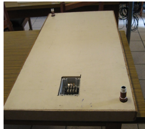
Figura 1.2 Aislamiento en la parte posterior del todo el sistema de refrigeración.
