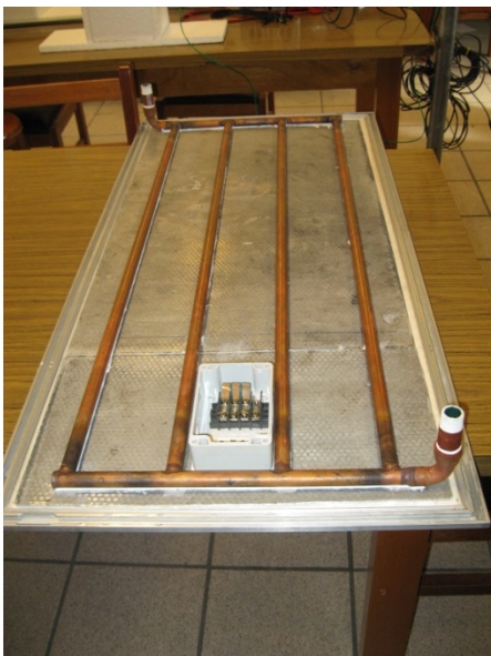
Figura 1.1 Disposición de las tuberías de cobre y la placa de aluminio, incorporada en el panel FV.
