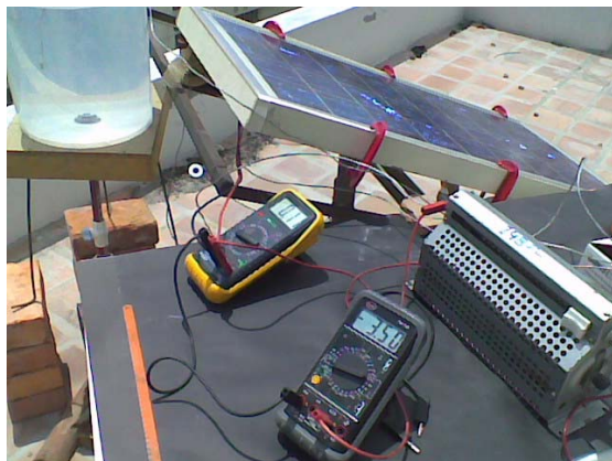
Figura 3.1: Esta figura muestra la disposición de los equipos de medida para la parte térmica y parte eléctrica.
