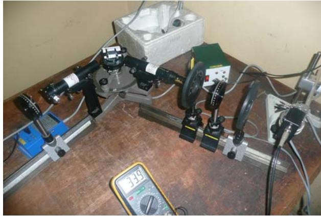
Figura 2 Elipsómetro de reflexión de tipo nulo
