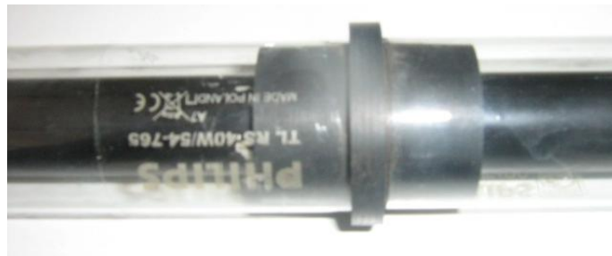
Figura 7: tubo absorbente con el cobertor de vidrio, y junta de unión entre tubos de vidrio
