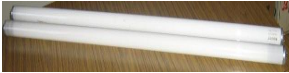
Figura 6: Tubos fluorescentes malogrados, utilizados como cobertor del tubo absorbente
