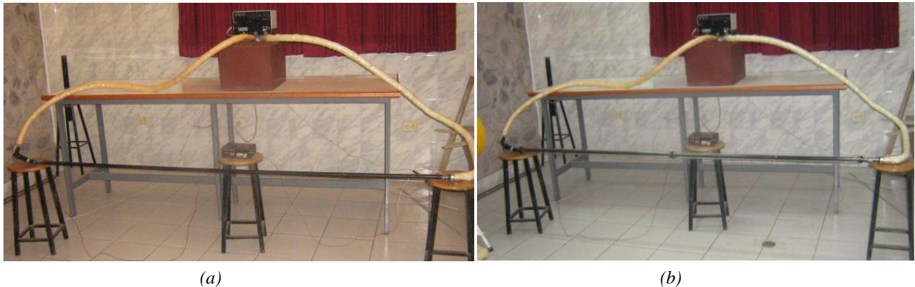
Figura 11: (a) equipo armado para la medición del coeficiente global de pérdidas, tubo absorbente sin el cobertor de vidrio. (b) equipo armado para la medición del coeficiente global de pérdidas, tubo absorbente con el cobertor de vidrio.
