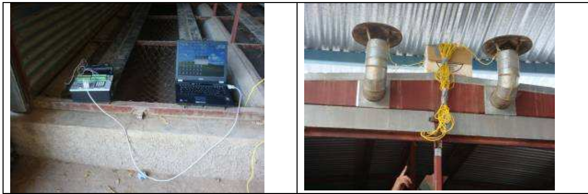
Figura 2- Configuración y programación del sistema de adquisición de datos e instalación final.
