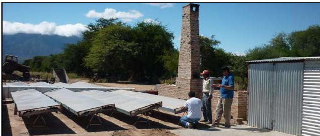
Figura 2: Fotografía del secador. Vista lateral este - oeste, con colectores dirigidos al norte.
