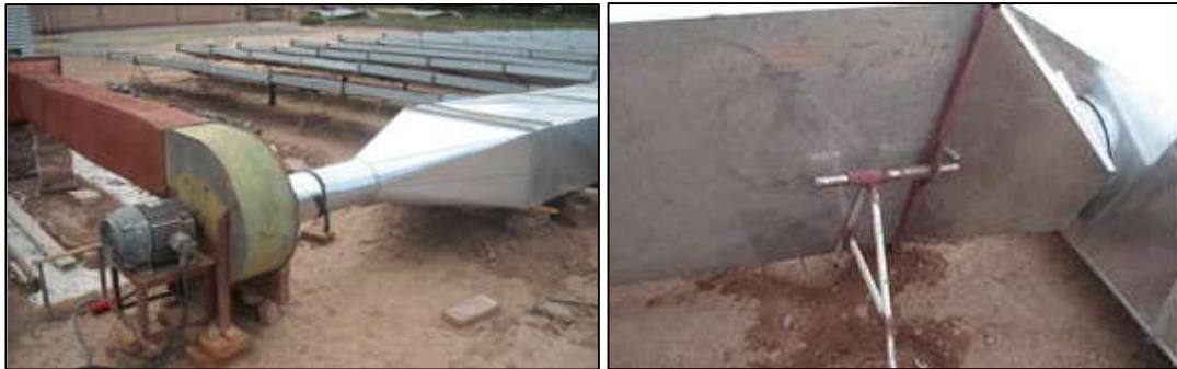
Figura 3,4: Ventilador y acople. Sistema de rotación de los colectores, campana de reducción y acople al caño maestro.
