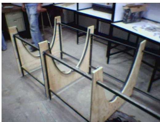
Figura 5.- Estructura estática del concentrador CPC
