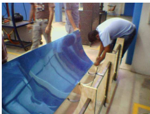
Figura 6.- Prueba de la colocación de las láminas de aluminio
