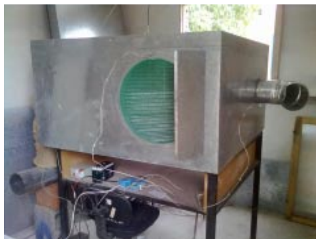
Figura 5 – Conducto de ingreso del circuito caliente (izquierda) y vista del intercambiador durante el ensayo (derecha).
