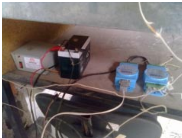
Figura 4 - Parte del equipo de monitoreo: fuente de CC, batería de 12 V, datalogger 4018 y conversor 4520.
