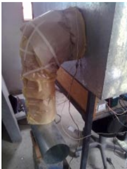
Figura 5 – Conducto de ingreso del circuito caliente (izquierda) y vista del intercambiador durante el ensayo (derecha).
