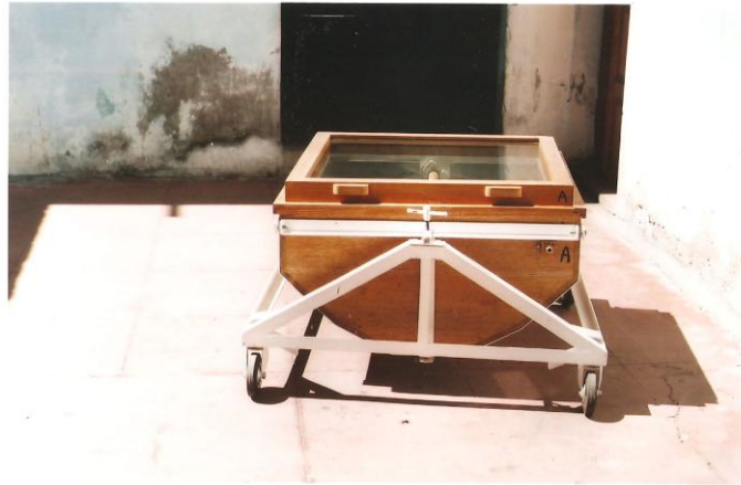
Fig. 6. Marco de madera con tapa y vidrios sobre concentrador y soporte metálico.
