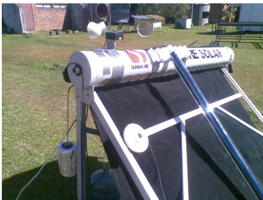
Figura 4. Imagem da bancada experimental para medidas do parâmetro transmitância-absortância solar
