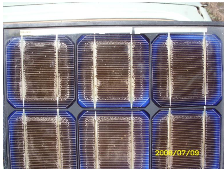
Figura 1. Foto obtenida de un conjunto de celdas de un módulo deteriorado
