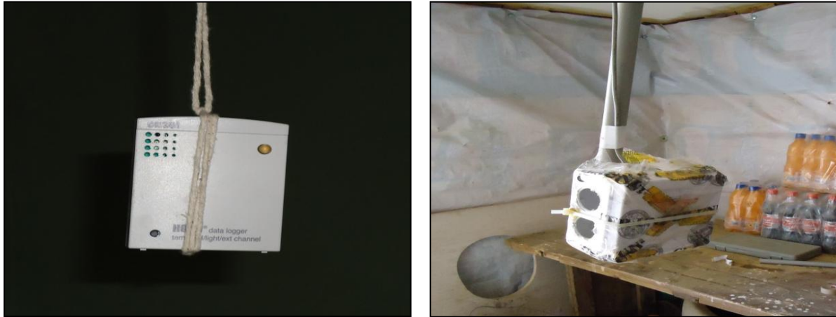
Figura 4. Izquierda: Micro-estación meteorológica HOBO. Derecha: Sensor de temperatura ubicado dentro de una caja de protección ventilada.
