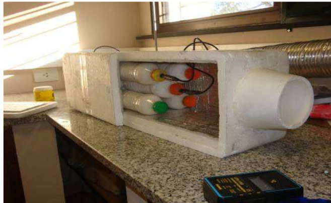
Figura 6- Sistema de acumulación construido en el Laboratorio. Vista disposición de botellas y termocuplas conectadas a las botellas.
