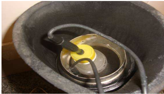
Figura 3- Vista superior del termo aislado y la botella con acetato de sodio ubicada en su interior.
