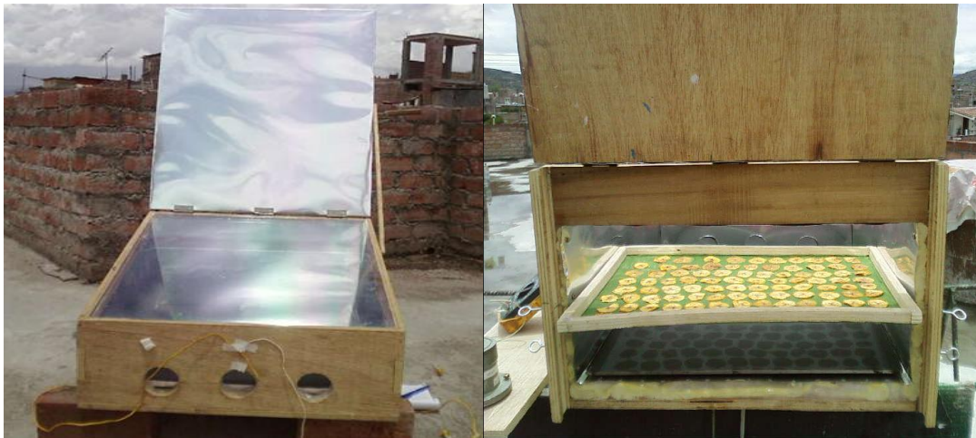
Figura 7 - Medida de la temperatura del aire de entrada a la cámara de secado. Módulo solar multipropósito secado plátano como muestra se su funcionamiento
