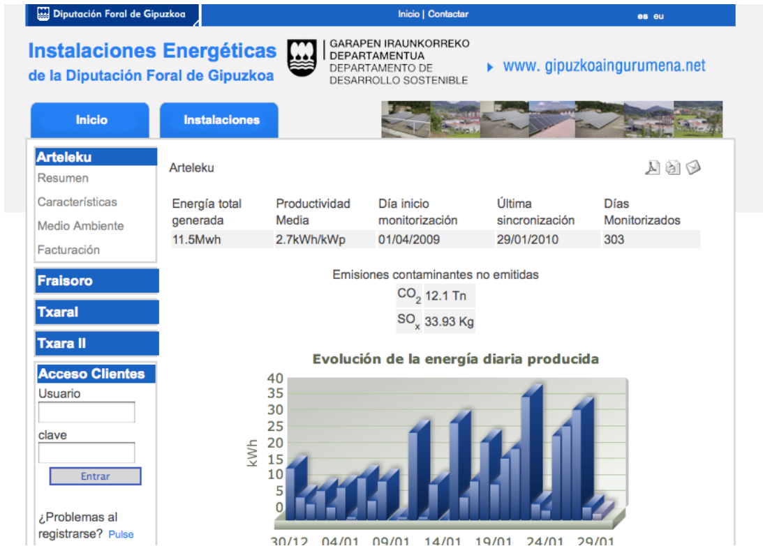
Figura 3.:Servicio web para la monitorización y evaluación de las plantas fotovoltaicas de la Diputación de Guipúzcoa.
